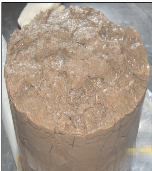
图 8 青藏粉质黏土冻融循环后裂隙面中层状冰
