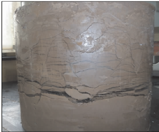
图 7 青藏粉质黏土冻胀裂隙
